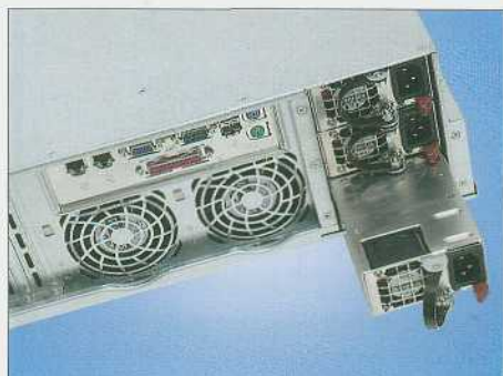
Tri napajanja, svako snage 380 W, zajedno čine redundantan podsustav napajanja
