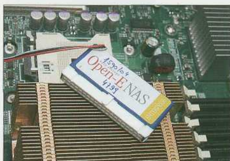
Modul Open-E NAS, srce ovog NAS-a, drastično olakšava izvedbu rješenja. U svega 256 MB ugruran je cijeli OS, što je impresivno
