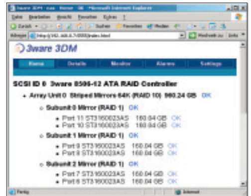
▲ Positiv: Aus dem Ancom-HTML-Menü gelangt der Administrator zur Konfiguration des integrierten 3Ware-Controllers in das Controller-HTML-GUI.
