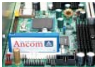
Afbeelding 1 Plaatsing module in IDE-poort.
