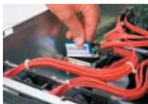
Afbeelding 3 Plaatsing module in IDE-poort.
