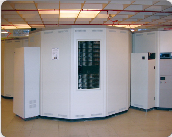
Das Rohdatenlager – die Tape-Library – ist die Datenschatzkammer des DESY. Trotz Robotik ist ein Bandspeicher viel zu langsam, weshalb die Daten auf File-Servern bereitgestellt werden müssen.
