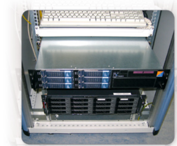
Auf das zweite Storage-Array, das ebenfalls ein Open-ENAS 2.0 steuert, sichern das Klinikum Oldenburg per Gigabit Ethernet online die Daten des Storage-Array NAS01.
