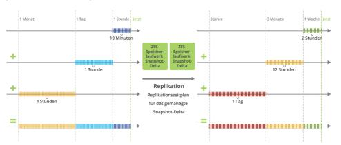
Alle 10 Minuten wird ein Speicherabbild des Metro-Clusters auf den Backup-Server asynchron repliziert, sodass sich folgende Retention auf dem Ziel ergibt:
